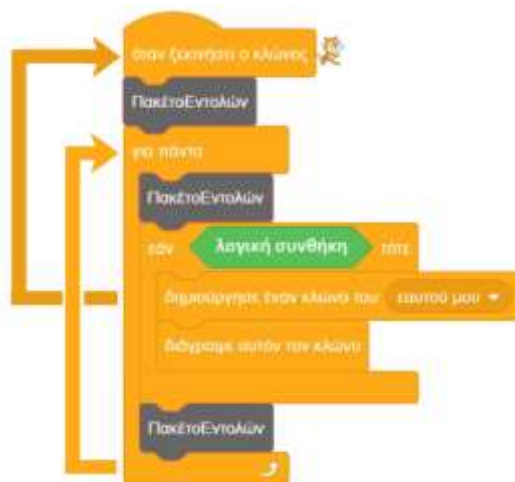
Σχήμα 9. Διασταυρούμενοι βρόχοι υλοποιούμενοι με χρήση κλώνου και εντολής επανάληψης.
