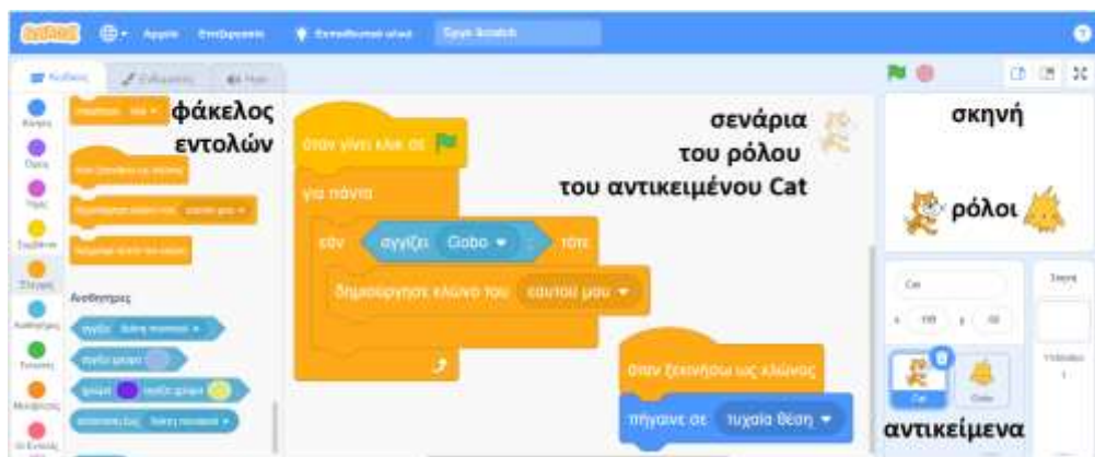
Σχήμα 2. Αντικείμενα/objects, ρόλοι τους/sprites στη σκηνή και σενάρια που καθορίζουν τη συμπεριφορά τους.
