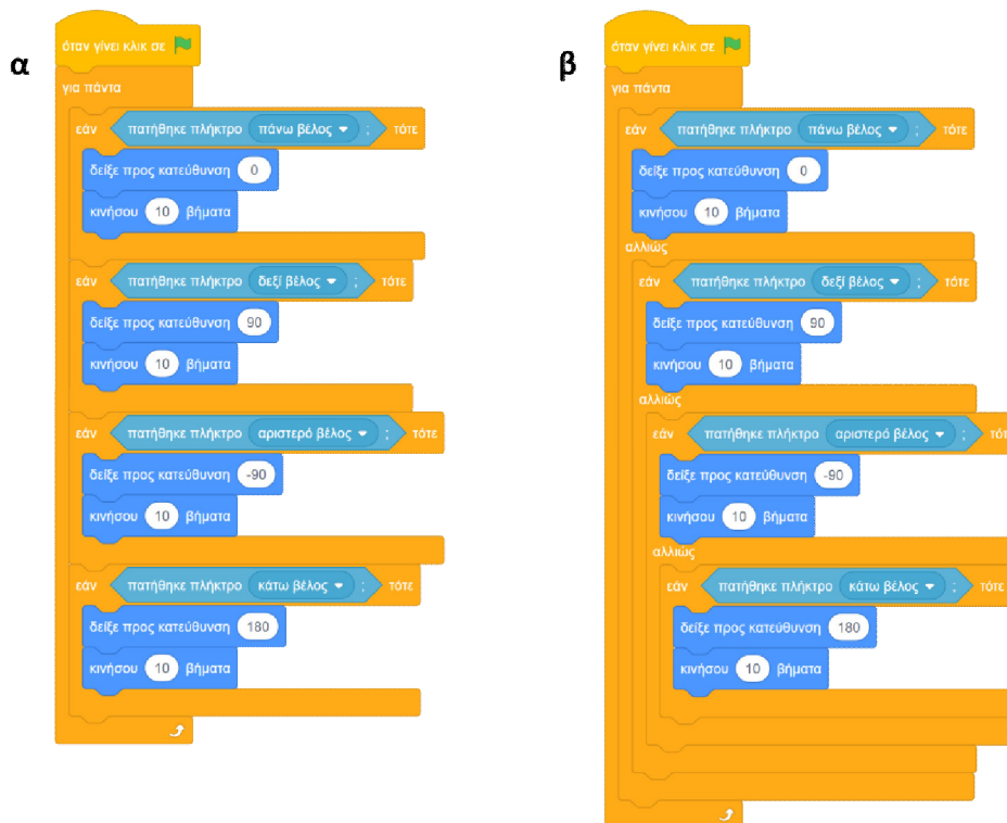
Σχήμα 2. Δύο διαφορετικά προγράμματα που το καθένα κάνει χρήση των εντολών (α) "εάν-τότε..." με γραμμικό τρόπο και (β) "εάν-τότε...-αλλιώς..." με εμφωλευμένο τρόπο, για να επιλύσει σειριακά το πρόβλημα του τηλεχειρισμού του ρόλου αντικειμένου.
